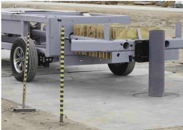
Nuestro completo programa de ensayos aborda específicamente la creciente demanda de dispositivos de protección en condiciones de impacto dinámico, garantizando el cumplimiento exhaustivo de la norma ASTM F3016 "Método de ensayo estándar para ensayos de sustitutos de dispositivos de protección contra impactos de vehículos a baja velocidad".
